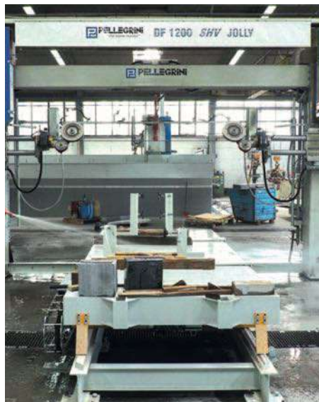
Pellegrini CNC Seilsäge im Einsatz
